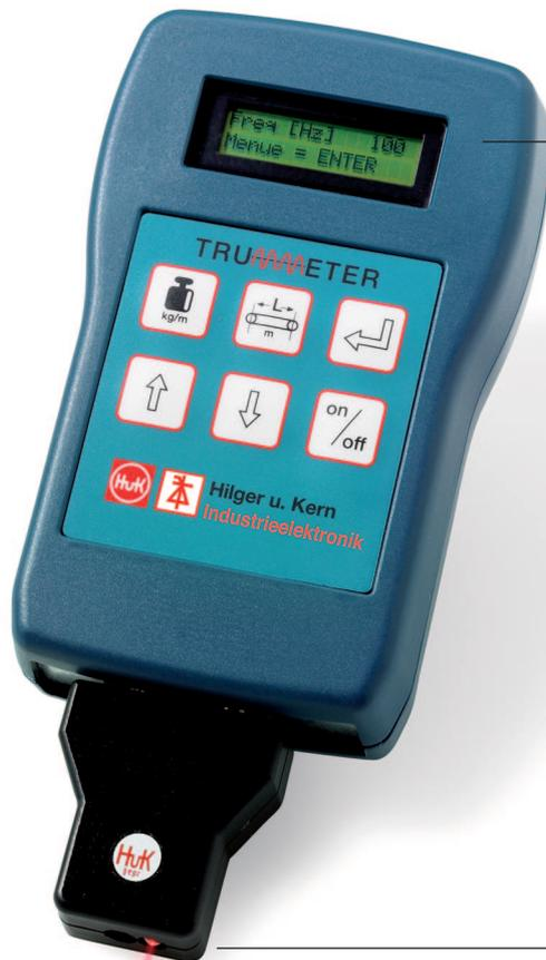
La sonde mesure la fréquence propre de la courroie tendue libre en utilisant la lumière
