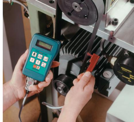
L'écart entre la courroie d'entraînement et la sonde doit se situer entre 3 et 20 mm. Positionnement : voir le dessin.
